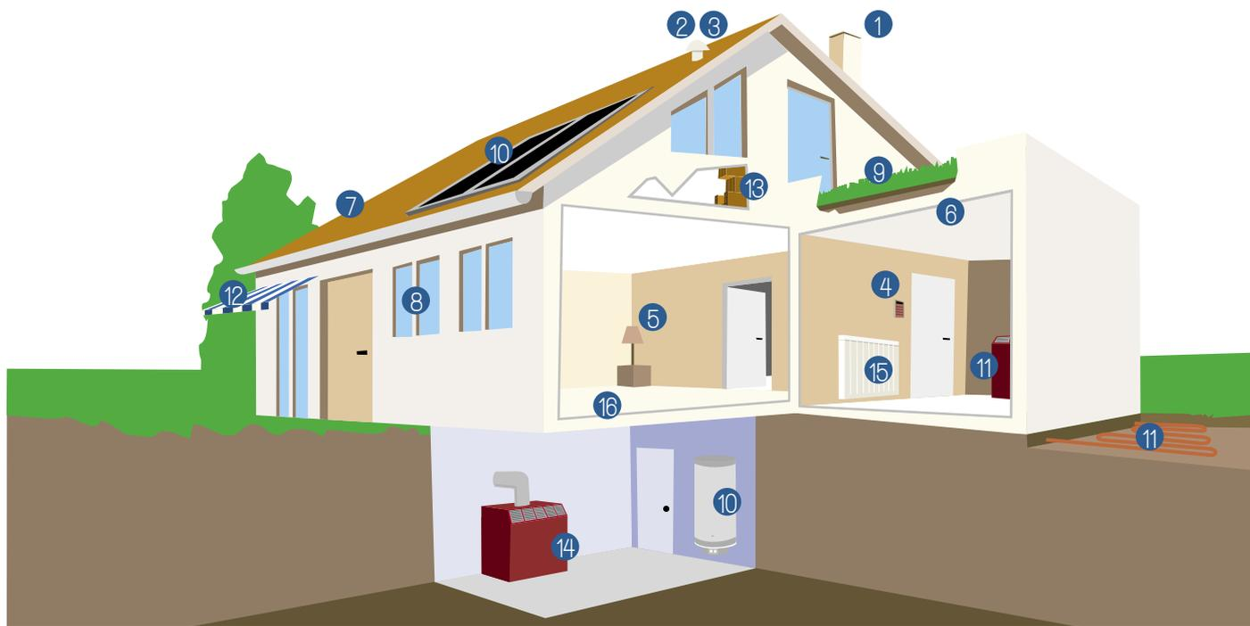
**1 Conduit de fumée** | Un conduit de fumée efficace, monté dans les règles de l'art et compatible avec le générateur, améliore la performance énergétique.
